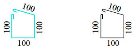
PLASĂ PENTRU GABIOANE- SUPRAFAȚĂ DESFĂȘURATĂ, SCARA 1:100
